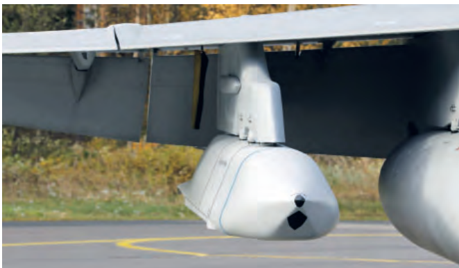
AGM-158A JASSM -risteilyohjus Hornet ulommassa ripustimessa. (© Samuli Haapala / Combat Camera)
