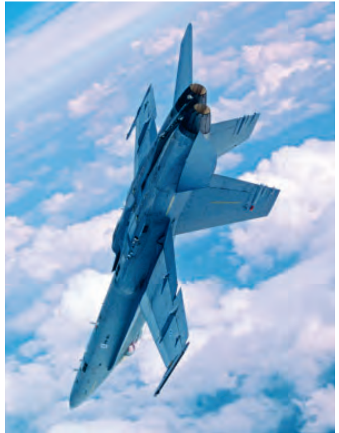
F-18C HN-414 saman silmukan laskevalla osalla. Rauhallisessa liikehtimisessä ohjausjärjestelmä G-rajoitin rajoittaa kuormituskerroimen noin 7,5:een. (© Jyrki Laukkanen)
