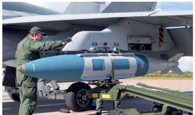
GBU-31 (Mk 84) 925 kg JDAM -täsmäpommi Hornetin ripustimessa Hallissa elokuussa 2011. (Koelentokeskus)
