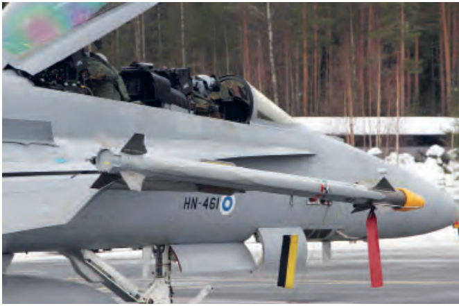
AIM-9X Sidewinder F/A-18D HN-461:n oikeassa siiven kärjessä. AIM-9X-ohjukset hankittiin MLU 1-päivityksessä. (Ilmavoimat)
