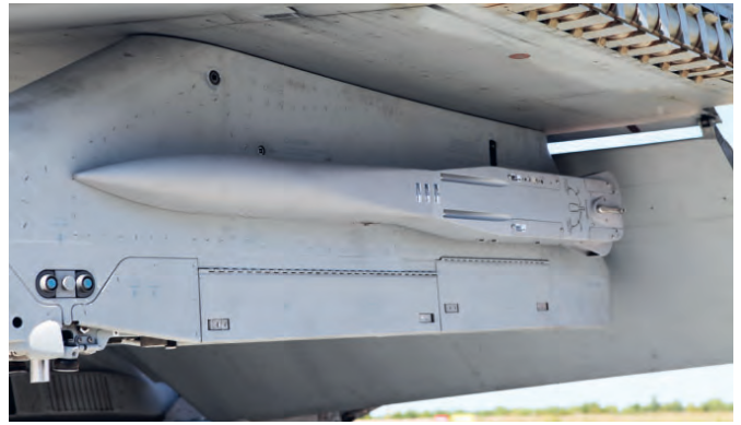
MLU 2:ssa Hornetiin asennettiin uusi Saabin BOL-omasuojaheitinjärjestelmä, jonka heittimet sijoitettiin siipiripustimien kylkeen. (© Jyrki Laukkanen)
