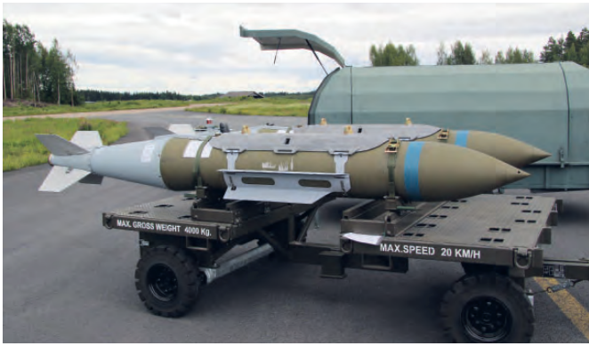
Kaksi 925 kg GBU-31V3 (BLU-109) JDAM -tunkeumatäsmäpommiä kuljetusalustalla. (Ilmavoimat)
