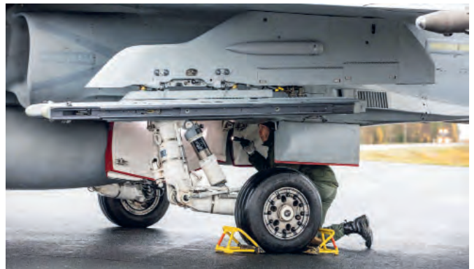
Ulomman siipiripustimen kaksoislaukaisukisko. (Ilmavoimat)
