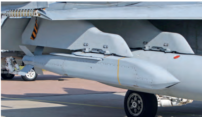
AGM-154C JSOW -liitopommi Hornetin oikean siiven ulkoripustimessa. (Koelentokeskus)
