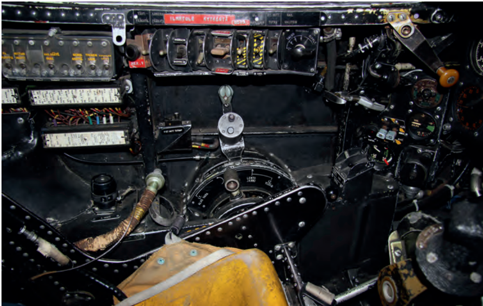
GN-101:n vasen sivuseinä laitteineen. Keskellä on kaasuvipu ja laskutelineen käyttövipu. (© Jyrki Laukkanen)
