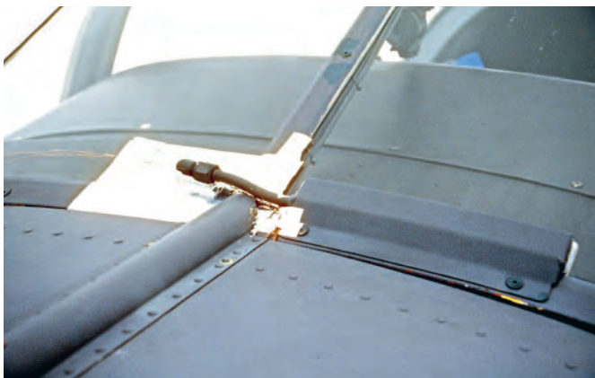
Redigon tuulilasin jäänpoiston eri kehitysvaiheita RG-10:llä vuosina 1994–95. (© Jyrki Laukkanen)
