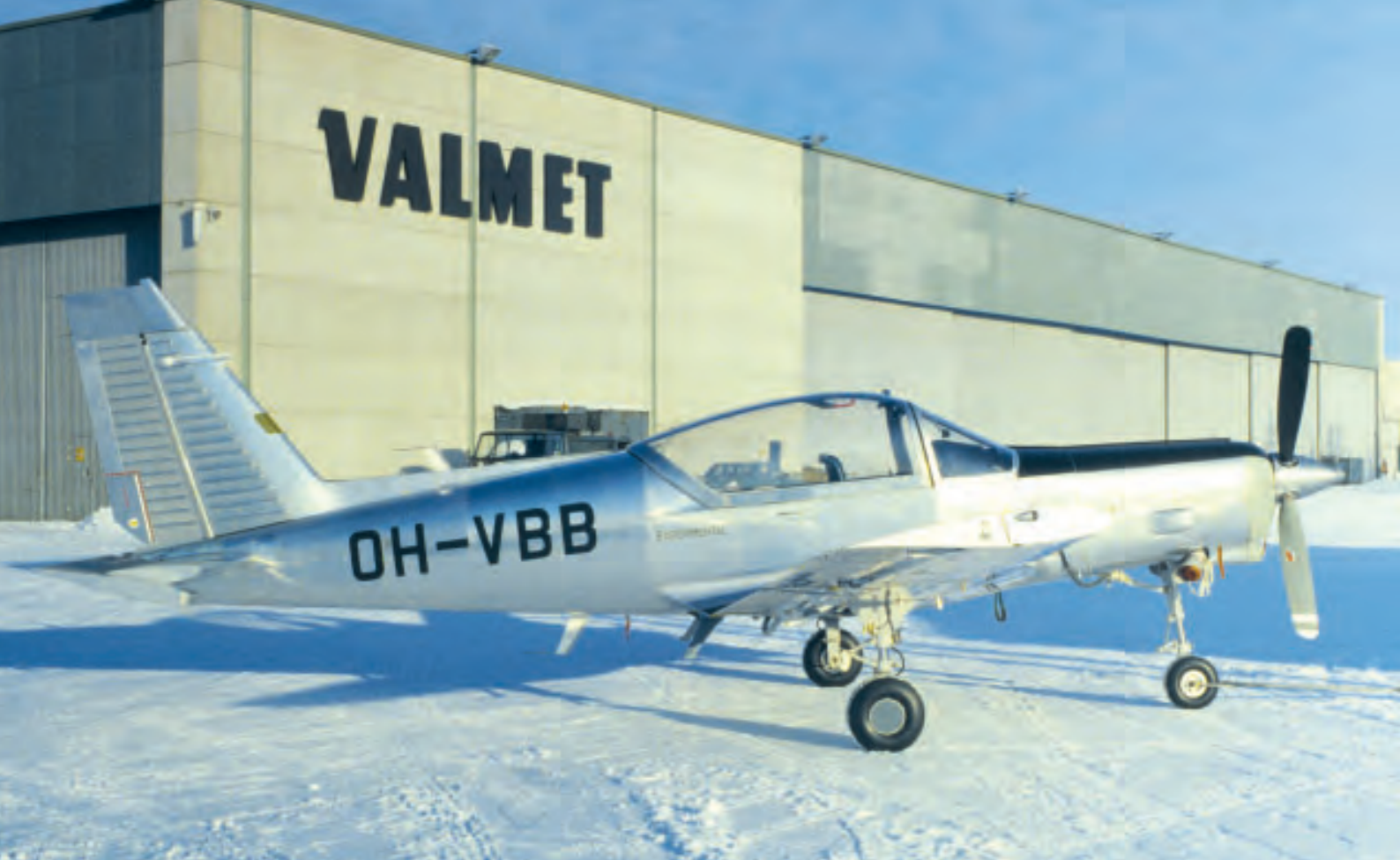
Upouusi Valmet L-80 TP Military Trainer eli Turbo-Vinha OH-VBB helmikuussa 1985. Ulkoiset erot Turbo-Lekoon ovat trapetsinen siipi ja sisään vedettävä laskuteline. (© Jyrki Laukkanen)
