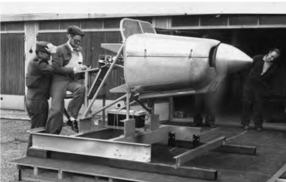
Leko-70:n moottoriasennus kokeiltiin erillisessä koetelineessä Tampereella. Kuvassa suunnitteluinsinööri Matti Ryynänen kirjaa koekäyttöarvoja. (Valmet)
