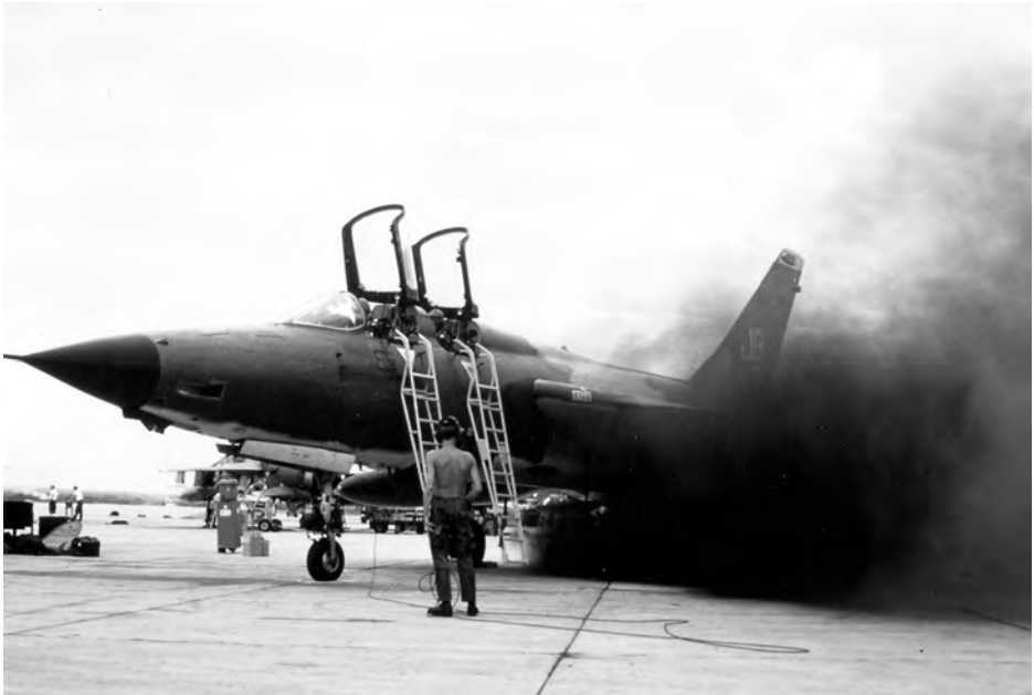
Kaksipaikkaisen Wild Weasel -koneen käynnistys starttipatruunalla täyttää ilman mustalla savulla. Kuva: USAF
